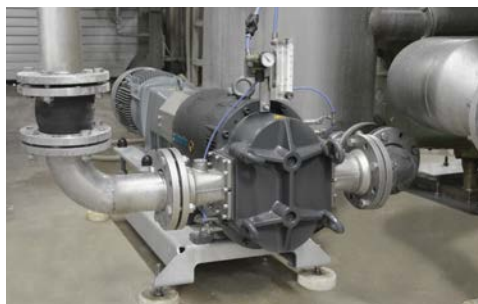
Насосы линии ONIXline для перекачки крахмала.
